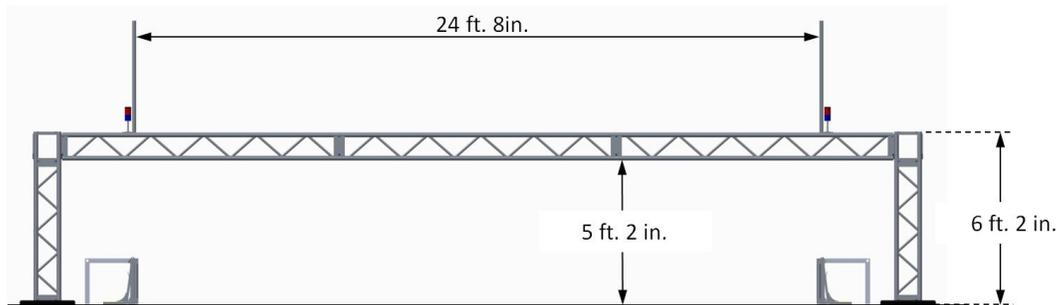
Figure 2-10: The TRUSS
